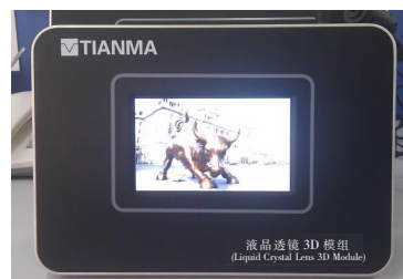
图 9 10.16 cm(4 in)液晶透镜 3D 样机照片
